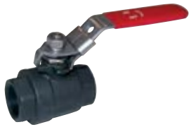
705 - Carbon steel - DIN 3202-4 M3 A216WCB body - CF8M ball.
